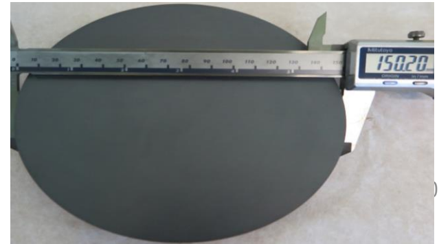
N型(導電型) 基板 4" , 6"
